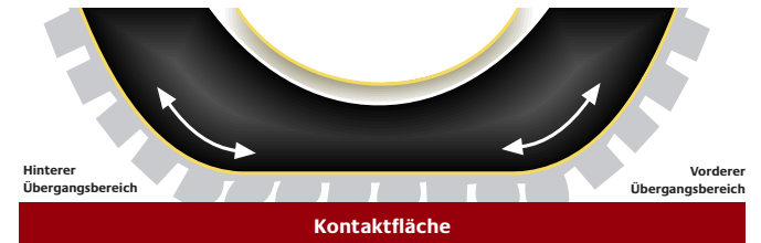
Abb.: Energieverlust aufgrund der Verformung in der Kontaktfläche
